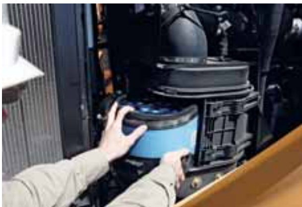
Воздушный фильтр легко меняется, а пыль отсасывается и сбрасывается в выхлоп
