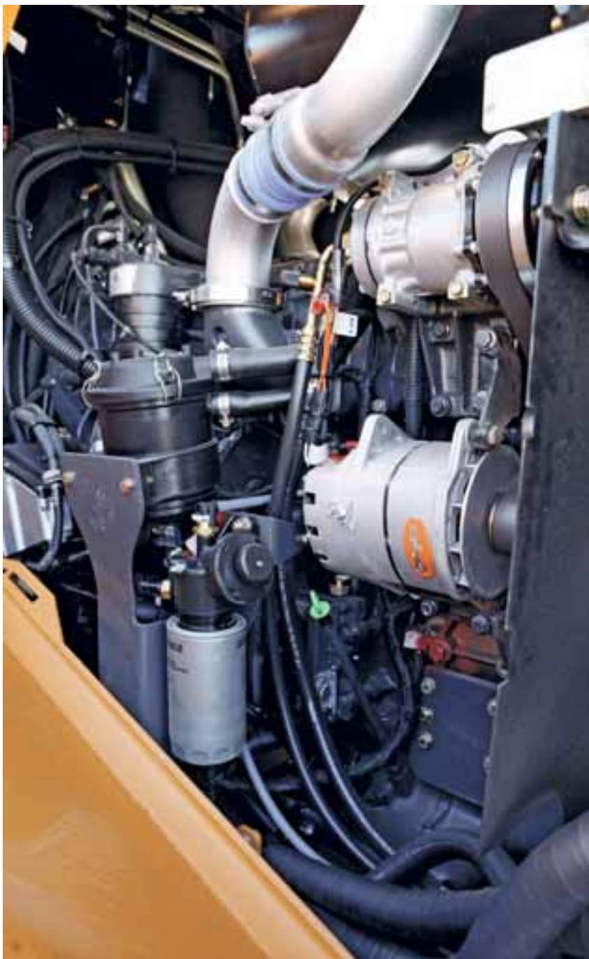
Топливный фильтр и сервисные точки моторного масла легко доступны с левой стороны машины, тогда как остальные фильтры располагаются под ступенями с правой стороны.
